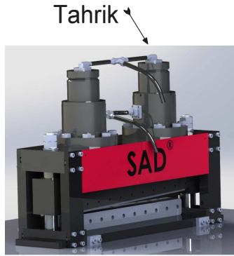
Şekil 7.2. Pnömatik ve Hidrolik Makas Piston Sistemi
